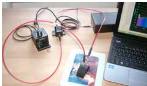
La conservation préventive devient parfois prédictive. Les travaux initiés au Getty Conservation Institute ont conduit à la réalisation du Microfade Tester portable, appareil de micro test in situ de sensibilité à la lumière. Cet instrument permet de mesurer, en quelques minutes, le changement de couleur
